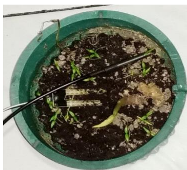
Gambar 18 Pengujian Sensor Suhu DS18B20
